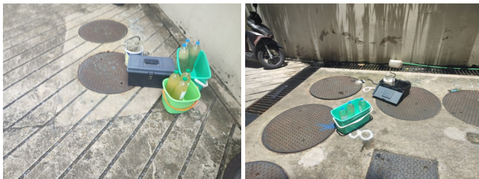
ภาพที่ 5-28 การเก็บตัวอย่างน้ำทิ้งที่บ่อเกรอะและบ่อพักน้ำใส
